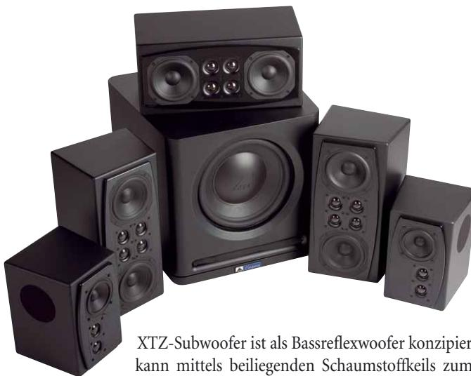
XTZ-Subwoofer ist als Bassreflexwoofer konzipiert. Er kann mittels beiliegenden Schaumstoffkeils zum geschlossenen Gehäuse umgewandelt werden. Das 300-mm-Tieftonchassis strahlt nach vorne ab und wird von einem leistungsfähigen Class-D-Aktivmodul mit Energie befeuert. Das gut ausgestattete Modul verfügt über Cinch- und XLR-Buchsen und mehrere Möglichkeiten, den Frequenzgang zu beeinflussen. Satte 500 Watt Sinus- bzw. 900 Watt Maximalleistung stehen dem Subwoofer zur Verfügung.
